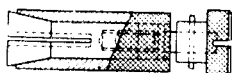
Fig. 2 - Clips consigliato per eseguire i collegamenti agli anodi della QQE06/40 quando il collegamento viene eseguito con filo flessibile.
